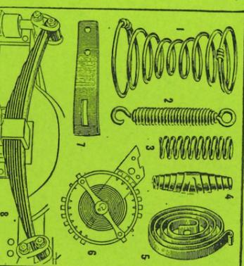
RESSORTS : 1. De sommeil; 2. A siffes solides tri-valliant à la traction; 3. A bonnets comprimés à la compression; 4. De séateur; 5. De mouvement d'horlogerie; 6. Spiral de balancier de montre; 7. A lame; 8. De suspension.
